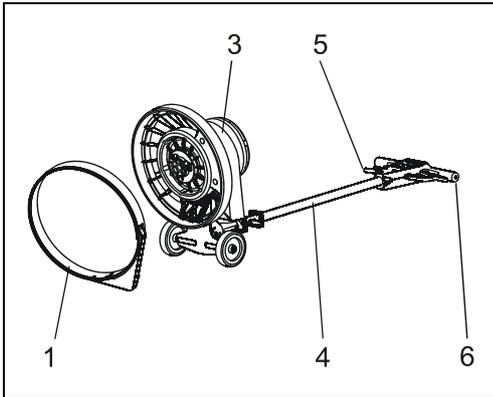
Abb. 10: Absaugring montieren
