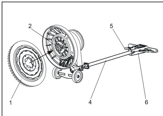
Abb. 16: Reinigungswerkzeug manuell einsetzen
