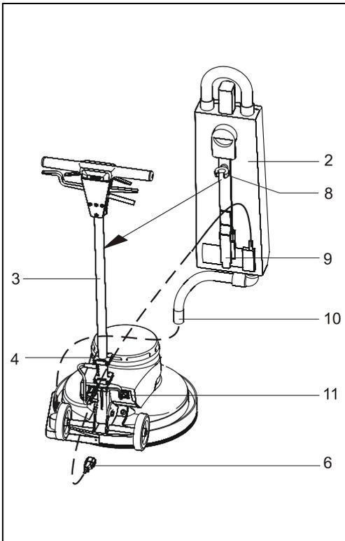
Abb. 12: Saugbehälter montieren
