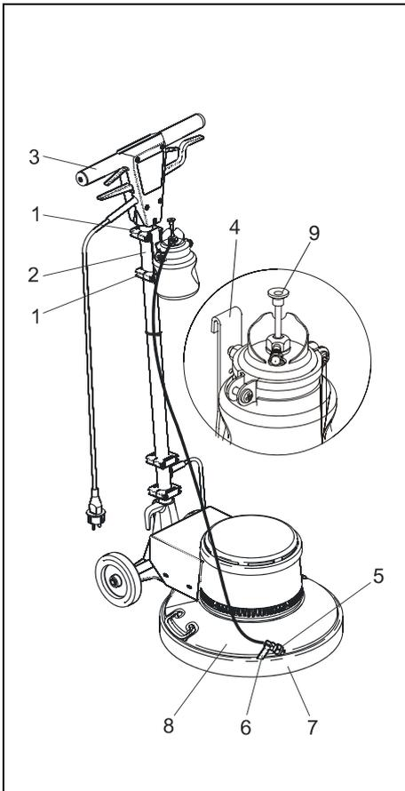
Abb. 7: Sprühgerät montieren
