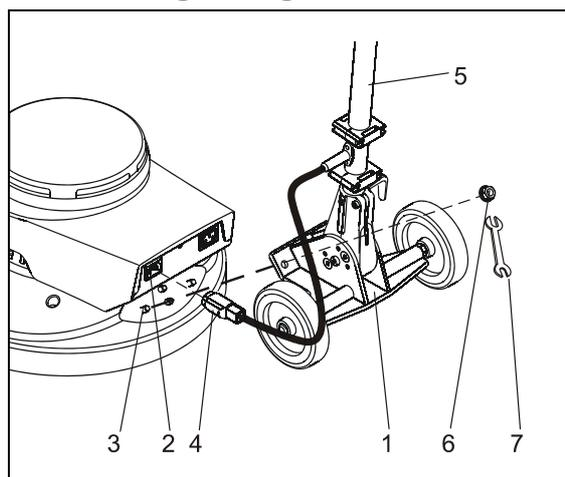
Abb. 5: Führungsstange montieren
