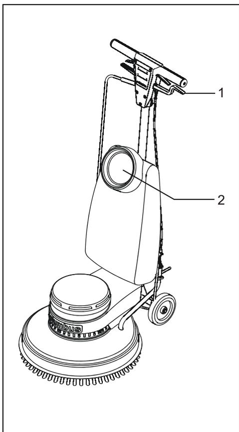
Abb. 9: Flüssigkeitstank befüllen
